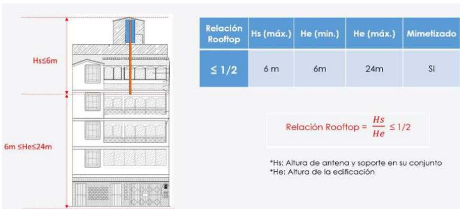
La altura máxima del mimetizado para todas las opciones tipo Rooftop es de seis (06) metros y la altura total de la edificación y mimetizado en su conjunto será máximo 30 metros, conservando la relación de aspecto de 1 a 2, siendo como uno (01) la altura del mimetizado y como dos (02) la altura de la edificación.
