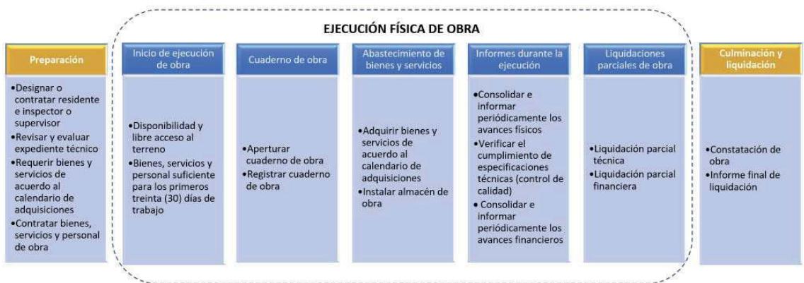
Figura 4 Fase de ejecución física de la obra
